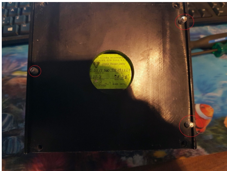
Figure 12 Les trois vis à ajuster pour mettre le réseau à niveau avant l'installation dans le spectrographe.
